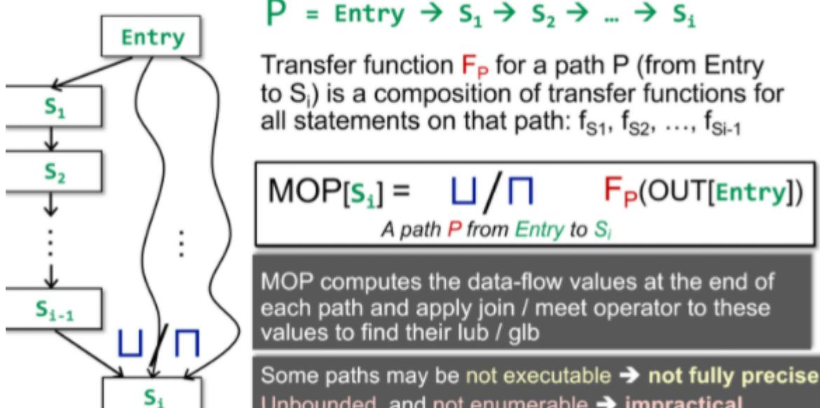
就是说, 之前数据流分析的结果是流敏感的, 而 MOP 的结果是路径敏感的, 例如下图所示的数据流,, 数据流分析的结果是  $\text{IN}[s_4] = f_{s_3}(f_{s_1}(\text{OUT}[entry])) \sqcup f_{s_2}(f_{s_1}(\text{OUT}[entry]))$ , 而 MOP 是  $\text{MOP}[s_4] = f_{s_3}(f_{s_1}(\text{OUT}[entry])) \sqcup f_{s_3}(f_{s_2}(\text{OUT}[entry]))$  (注意  $f_{s_3}$  的位置)
